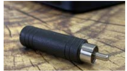
Abbildung 6 Adapter Klinkenbuchse 6.3mm auf Cinch-Stecker
